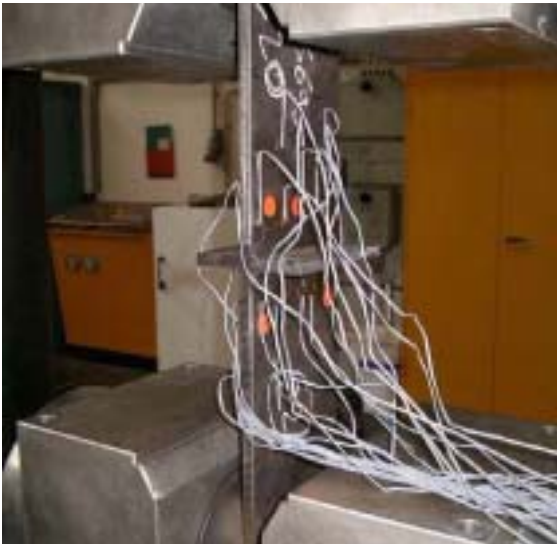
Bild 6. Probe mit Dehnmessstreifen
