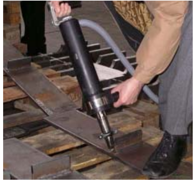
Bild 2. UIT-Behandlung der Proben
