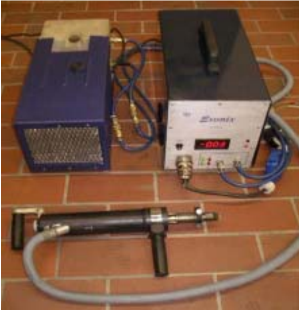
Bild 3. US-Generator mit Handgerät und Kühlaggregat
