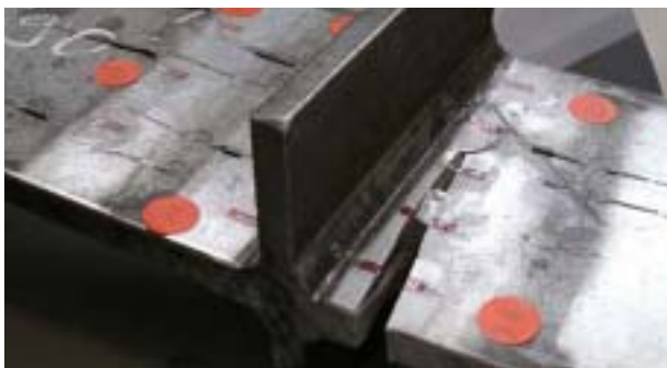
Bild 10. Bruch im Grundwerkstoff bei S690
