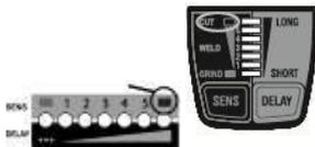
Wenn sich die Kassette bei Nichtbenutzung nach einer Stunde automatisch ausschaltet, schaltet sich auch die feste Einstellung „Dunkel“ automatisch mit ab. Die gewünschte Dunkelstufe für die feste Einstellung wird über die SHADE/ON Taste gewählt.
