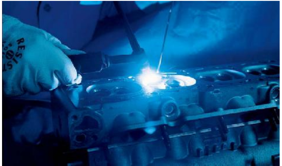
^ WIG-Gleichstrom-Schweissen mit minusgepolter Elektrode
