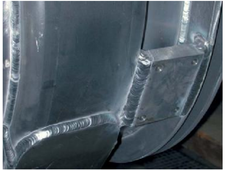
^ MISON®He 20: MIG-Schweisnaht an Aluminium-Behälter
