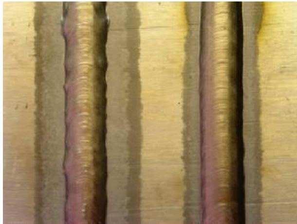
Bild 6: MIG-Blindraupe auf mechanisch gereinigtem Aluminium. Vergleich der Schutzgaswirkung, Argon (links), VARIGON® S (rechts). Unter VARIGON® S sind ein schmalerer Nahtbereich und die feinere und regelmäßige Schuppung zu erkennen.
