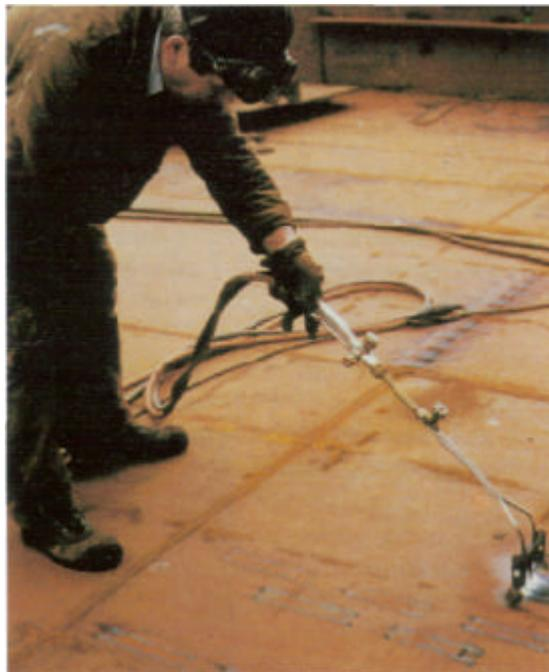
Bild 1. Flammrichten eines Schiffdecks
