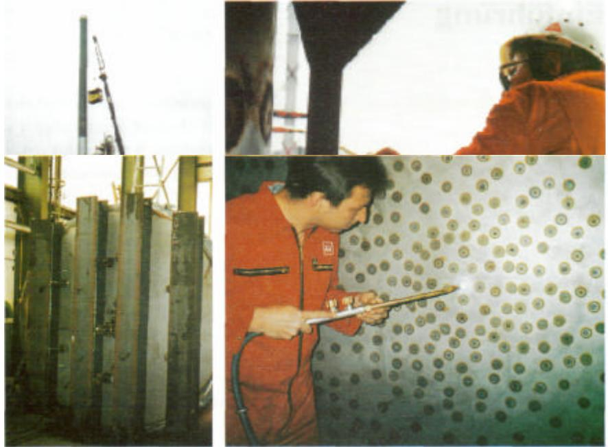
Bild 3a und 3b. Flammrichten eines Behälterbodens aus austenitischem CrNi-Stahl
