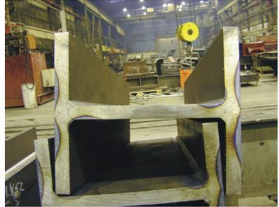
Ein Wärmestrich ist dann besonders wirkungsvoll, wenn nur  $\frac{1}{3}$  der Werkstückdicke auf Flammrichttemperatur erwärmt wird.
