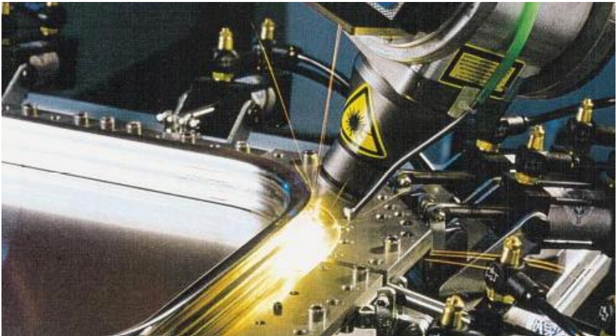
Bild 10: Schweißen von Membranringen mit Nd:YAG-Laser
