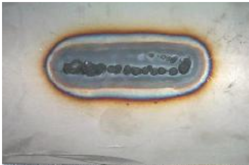
Bild 1. Anlauffarben auf der produktberührten Seite eines CrNi-Stahlrohres
