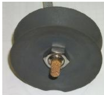
Bild 8. Formiergaseintritt aus porösem Sintermetall
