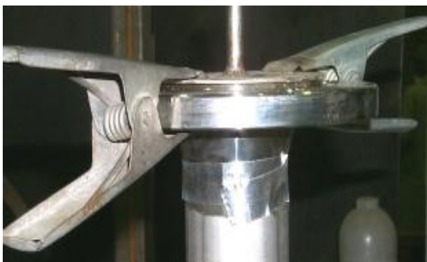
Bild 6 Flanschabdichtung beim Schweißen von CrNi-Stahlrohren
