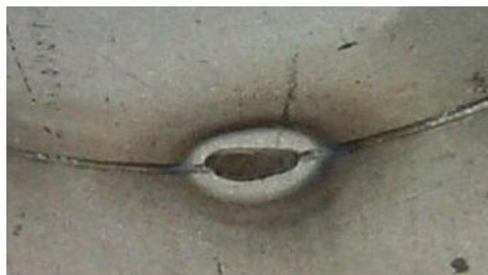
a) „unverbrannte“ Heftstelle an der Wurzelseite
