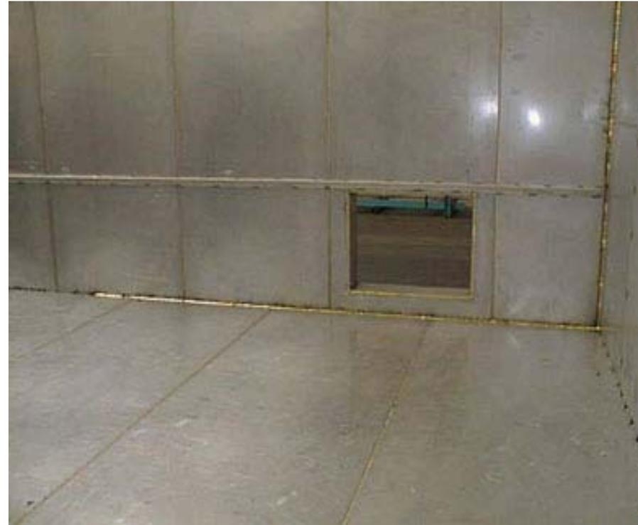
MIG-Löten von aluminieren Stahlblechen mittels TPS 4000.
