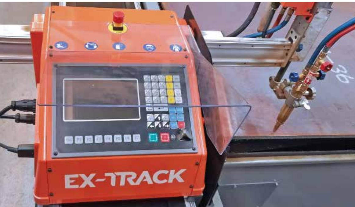
Die Display-Schutzabdeckung besteht aus 3mm Polycarbonat und schützt das Display und die Tastatur der EX-TRACK® CNC Steuerung.
